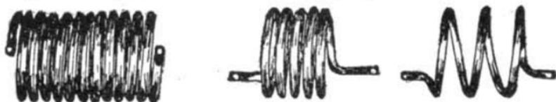
Fig. 24.9. - Bobine per ultrafrequenze.
