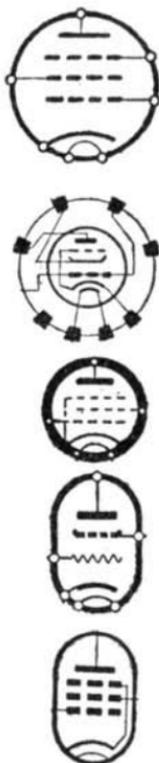
Fig. 9.13. - Cinque diversi modi, equivalenti, di disegnare le valvole radio.
