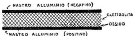
Fig. 5.5. - L'ossido di alluminio è presente sul nastro positivo ed è mantenuto dall'elettrolita.
