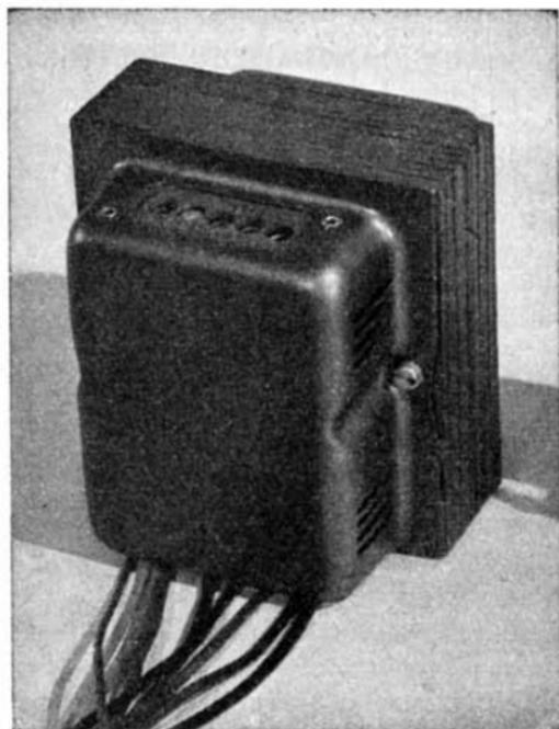
Fig. 16.1. - Trasformatore di alimentazione in custodia con cambio-tensioni.
