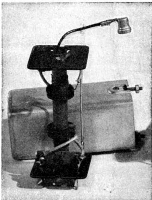
Fig. 13.3A. - Trasformatore di media frequenza.
